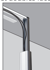
"placer la goulotte et tirer les câbles"
